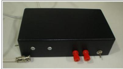
Figura 6. 16 – Fotografia do gerador de flutuações de tensão desenvolvido.
